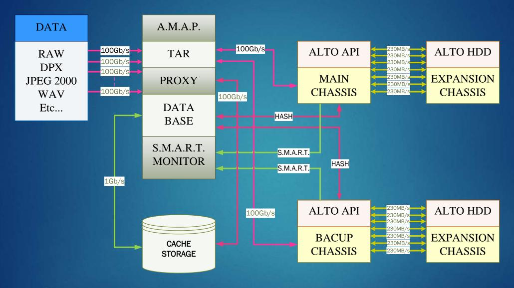
Система управления данными: ALTO MANAGER APLICATION SOFTWARE (A.M.A.P.)
