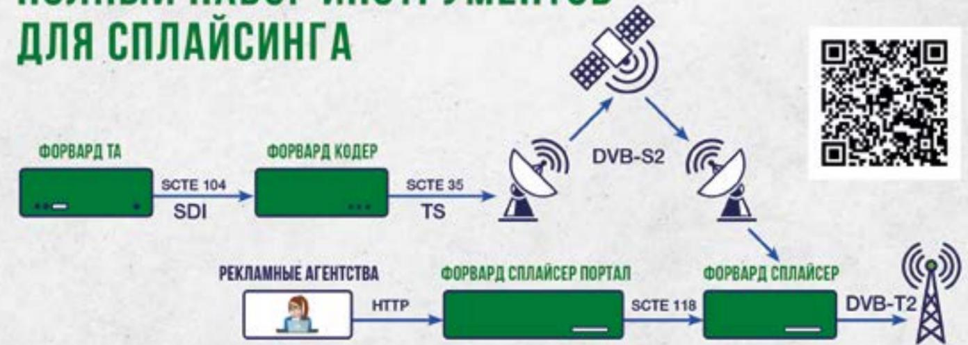
ВРЕЗКА В ТРАНСПОРТНЫЙ ПОТОК БЕЗ ТРАНСКОДИРОВАНИЯ:
